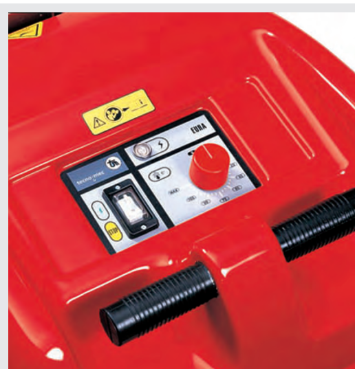
Quadro comandi: allarmi e indicatori, on/off pompa, regolazione temperatura (termostato).
