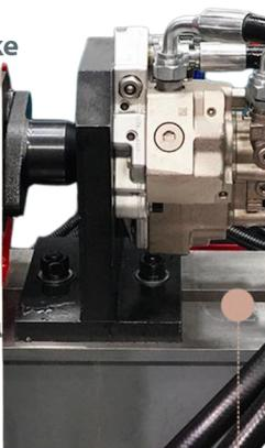
jednostavno testiranje svih Common rail pumpi sa univerzalnim prihvatom koji omogućuje stabilno testiranje i jednostavnu montažu. Podržava sve svjetske proizvođače CR pumpi
